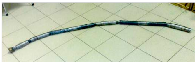
Рис. 3 – Сборка КНБК перфоратора с гибкими соединениями для испытаний на стенде УГНТУ
