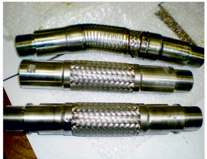
Рис. 11 — Деформация и разгерметизация многослойного гибкого соединения — сверху, снизу — новое гибкое соединение с дополнительным слоем
