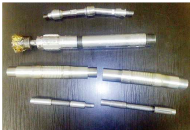
Рис. 6 – Шпиндельная секция с шарнирным соединением (сверху) и гибкие межкорпусные и межротаторные сочленения перфоратора (внизу)
