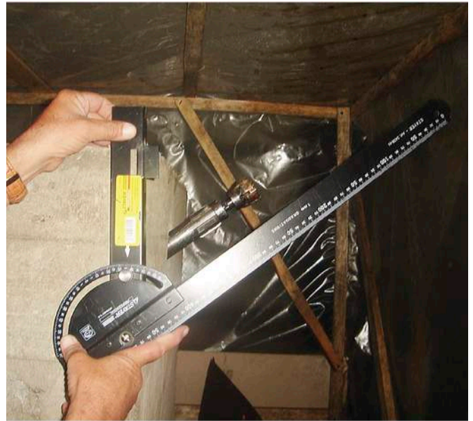
Рис. 10 — Замеры радиусов кривизны
