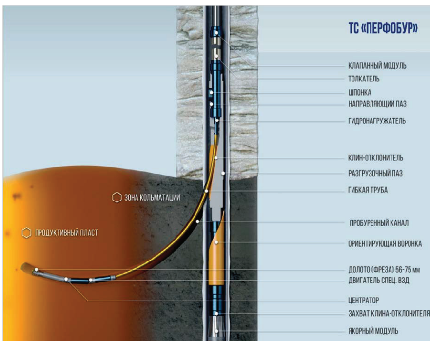
Рис. 1 — Компоновка технической системы (ТС) "Перфобур"
