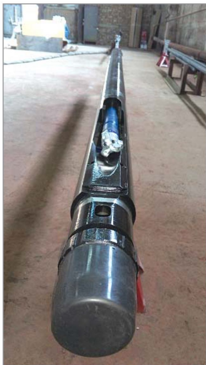
Рис. 4. Буровой и фрезерующий модули
